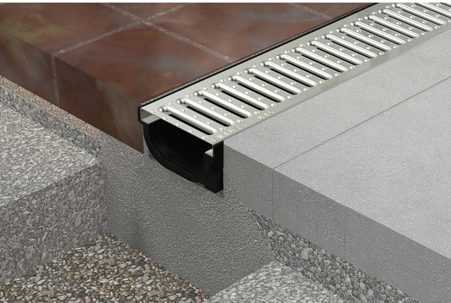
VZOROVÉ ULOŽENÍ DLE TŘÍDY ZATÍŽENÍ
