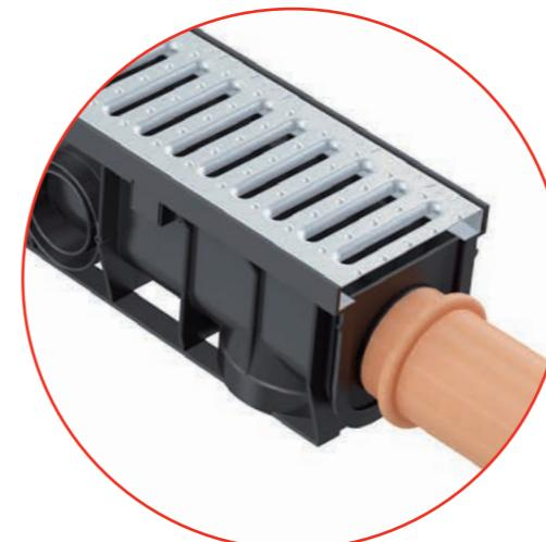
Pro dodatečné napojení přítoku obsahuje žlab čtyři přichystané boční otvory, které jde osadit trubkou DN50. Do čela lze napojit přítok DN75 a DN110.
